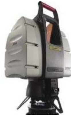
3D レーザースキャナ (高精細空間測量用)
